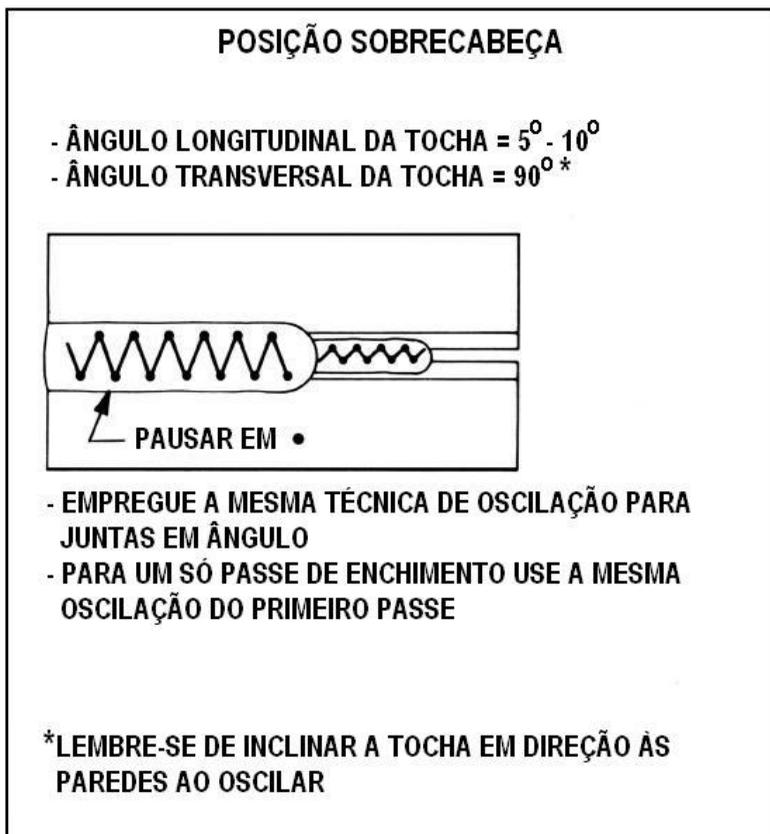
Figura 38 - Manipulações da tocha na posição sobrecabeça
