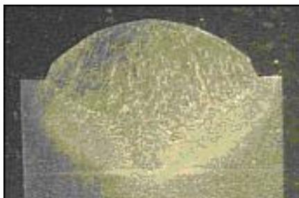
Figura 17 - Perfil *dediforme* obtido na soldagem MAG empregando arame sólido cobreado e uma mistura Ar/CO<sub>2</sub>
