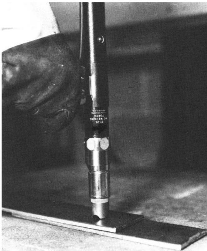
Figura 60 - Técnica de execução de uma solda pontual
