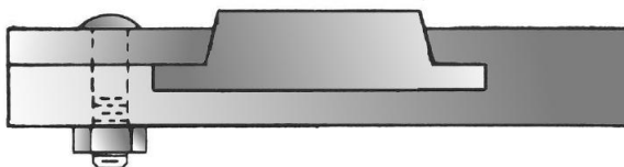
(b) Método de evitar empeno por restrição mecânica em cobre-juntas de cobre
