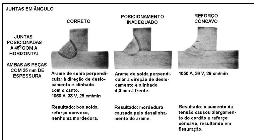
Figura 74 - Efeito do posicionamento do arame na forma do reforço de solda em juntas em ângulo
