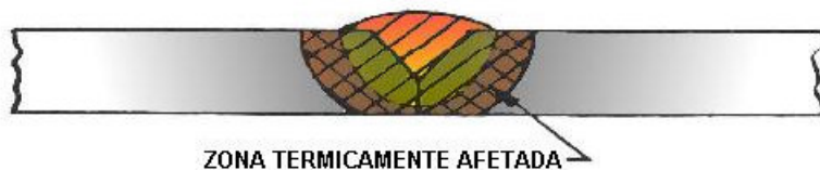
Figura 22 - Zona termicamente afetada
