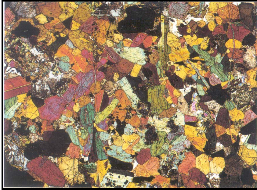
Şekil 4.7. İdiomorf tanelerden oluşan hornblendit (tamamen hornblentten oluşan bir kaya türü) (X7, //N).
