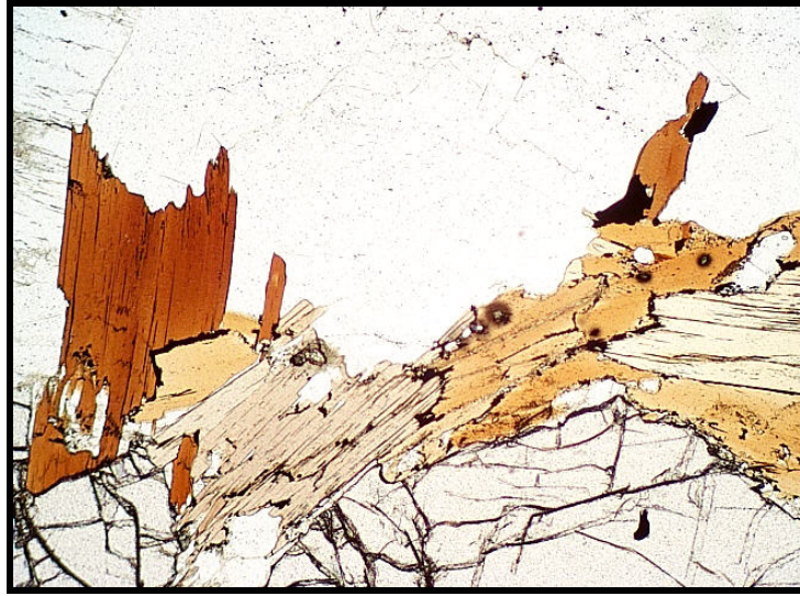
Şekil 1.15. Kahverengi pleokrizma sunan ve tek yönde dilinimleri oldukça iyi gözlenen bir biyotit örneği (//N, X40).
