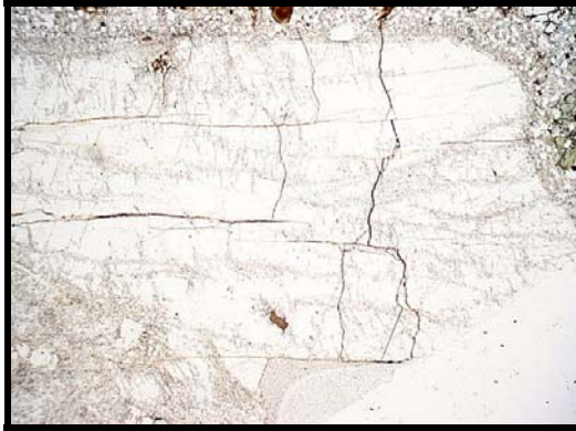
Şekil 2.1: Sanidin fenokristaline ait (a) //N ve (b) +N görüntüleri.
