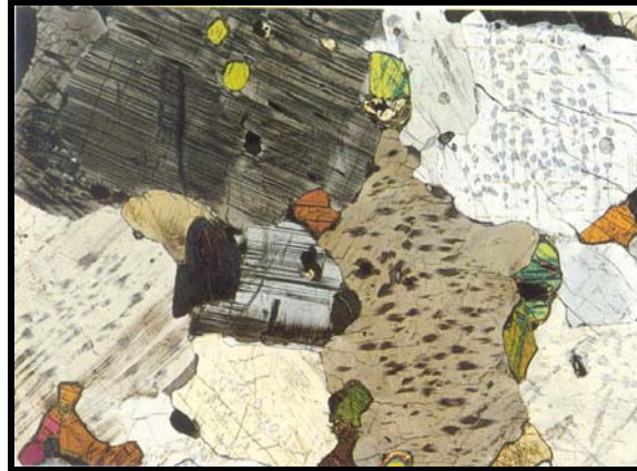
Şekil 4.12. Plajioklas kristalleri içinde alkali feldispat (ortoklas) inklüzyonlarından oluşan antipertit yapısı (Tonalitik Gnays, X20, +N).
