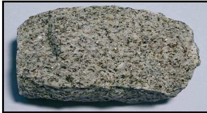
Şekil 4.4. Faneritik taneli bir granit el örneği (Aynı zamanda holokristalen dokuludur).
