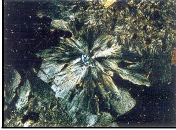
Şekil 4.20. Riyolit içinde gözlenen sferolitik doku (X27, +N)
