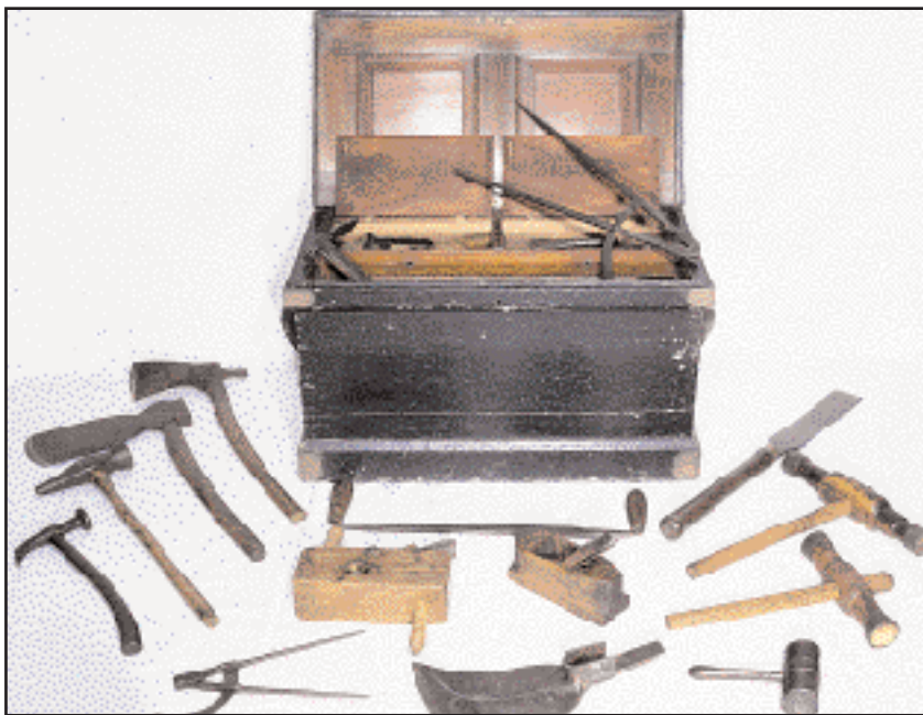
Κασέλα караβομαραγκού. Διακρίνονται τα εργαλεία που χρησιμοποιούνται για πρόχειρες επισκευές πάνω στο πλοίο. Εκθέμα του Ναυτικού Μουσείου Οινουσσών (φωτ.: Βασ. Γεωργιάδης).
