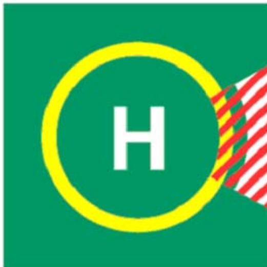
Rysunek 5-5. Oznakowanie sektora lotniska dla śmigłowców na morzu na którym lądowanie jest zabronione.
