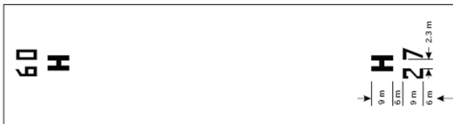
Rysunek 5-3. Oznakowanie obszaru końcowego podejścia i startu FATO
