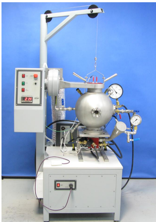
Rysunek 10. Stanowisko badawcze do pomiarów parametrów wybuchowości mieszanin pyłowo-powietrznych ( P_{\max} , DGW, GGW, GST, dp/dt_{\max} ) wg serii norm PN-EN 14034 w CNBOP-PIB.
