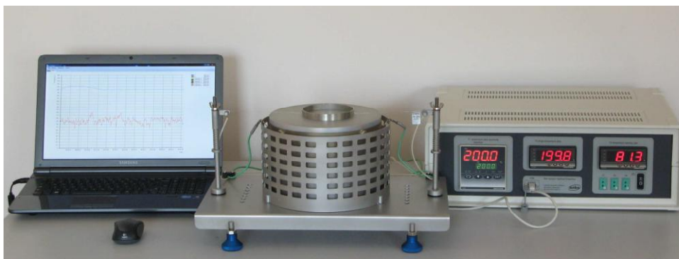
Rysunek 8. Stanowisko badawcze do pomiarów minimalnej temperatury zapłonu warstwy pyłów wg PN-EN 50281-2-1 w CNBOP-PIB.
