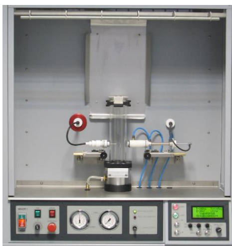
Rysunek 9. Stanowisko badawcze do pomiarów minimalnej energii zapłonu pyłów wg PN-EN 13821 w CNBOP-PIB.
