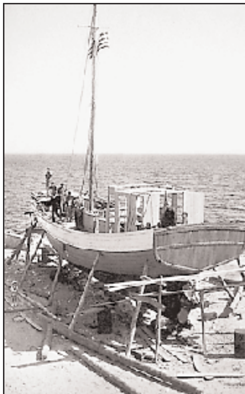
Το σκάρωμα ενός βαρκαλά στο ναυπηγείο των Πάχων στο Τηγάνιο (Πυθαγόρειο), στο Μεσοπόλεμο.
