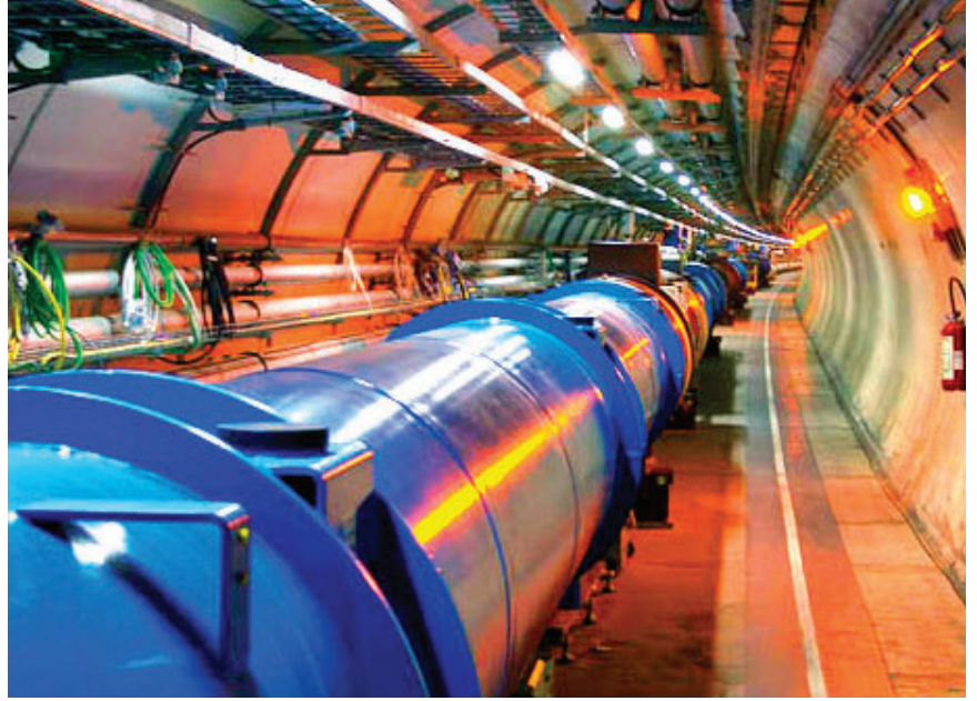
Hızlandırıcı tünellerinde elektrik yüklü parçacıklar güçlü süperiletken mıknatıslarla yönlendirilerek, ışık hızının çok yakınına kadar hızlandırıldıktan sonra kafa kafaya çarpıştırılıyorlar.
