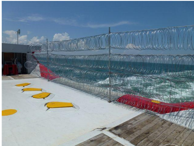
Buque AHTS alambrado en su popa muy baja contra abordaje de piratas. Foto DOF
