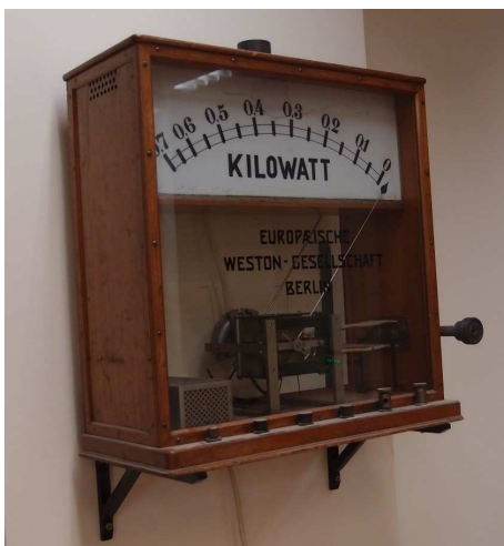
Fot. 11. Zabytkowy model demonstrujący działanie watomierza na ekspozycji w Laboratorium Miernictwa Elektrycznego PG (fot. autora)
