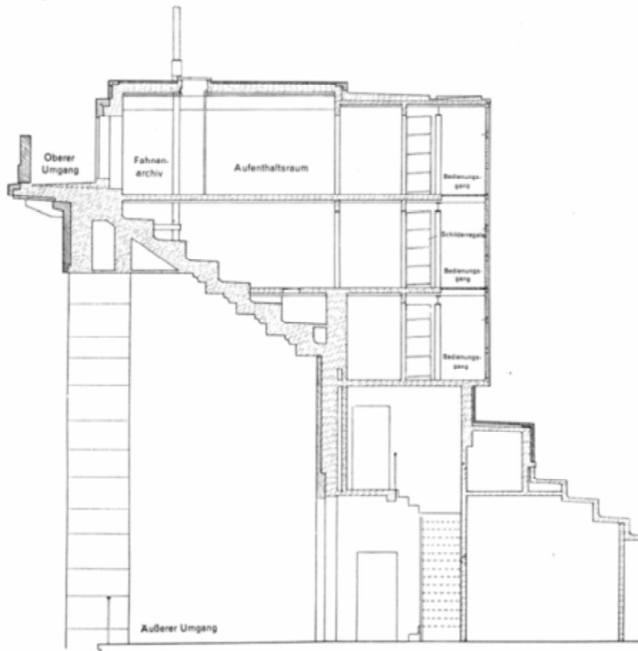
Schnitt durch die Anzeigetafel
