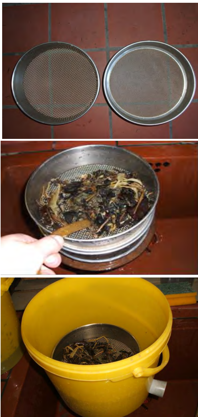
Ryc. 26. Zestaw sit o wielkości oczek 500 \mu\text{m} i 2 mm – stosowany do przepłukiwania podpróbek i redukcji substratu mineralnego w laboratorium oraz usuwania detrytusu i zmacerowanych części roślin (na dolnym zdjęciu: wiadro, służące do przepłukiwania podpróbek i dostosowane do bezpiecznego usuwania sedymentu) (Fot. M. von Bertrab)
