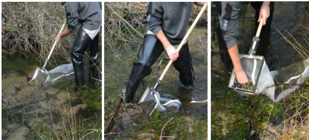
Ryc. 10. Pobór wielosiedliskowych próbek makrobezkręgowców wodnych z drobnoziarnistego substratu mineralnego (zdjęcie po lewej) oraz z podłoża organicznego: makrofitów (zdjęcie środkowe i po prawej) (Fot. B. Bis)
