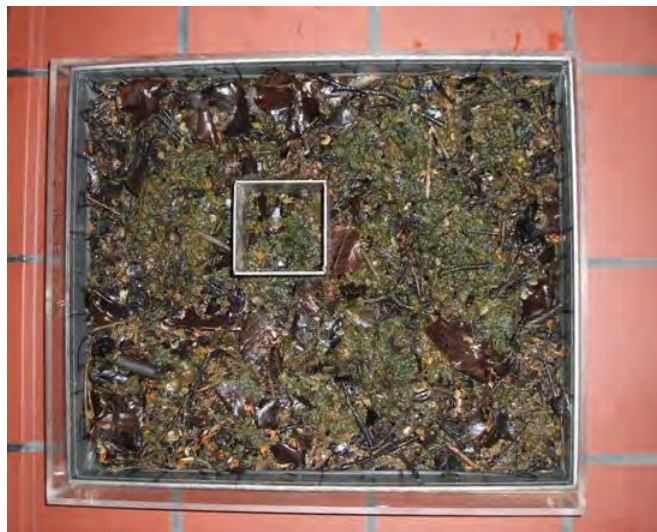
Ryc. 23. Równomierne rozmieszczenie zawartości całej pobranej próbki na sicie jest podstawowym warunkiem odpowiedniego przygotowania materiału do poboru podpróbek (Fot. M. von Bertrab)
