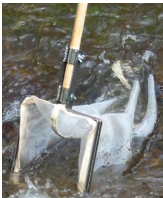
Ryc. 12. Siatka hydrobiologiczna do poboru makrobezkręgowców bentosowych, według wytycznych normy: PN-EN 16150:2012E (Fot. B. Bis)
