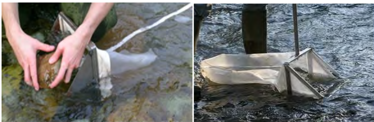
Ryc. 13. Czerpacz typu Surber do poboru wielosiedliskowych próbek makrobezkręgowców bentosowych z siedlisk o gruboziarnistym substracie mineralnym (Fot. B. Bis)
