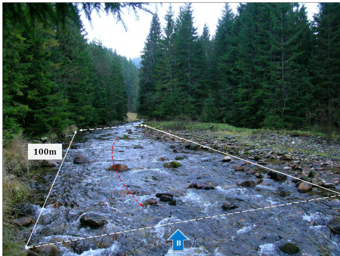
Ryc. 7. Szkic lokalizacji miejsca poboru próbek w potoku Chochołowskim (Tatry Zachodnie). Zaznaczono: miejsce poboru próbek: odcinek 100 m; kierunek poboru próbek w badanym odcinku rzeki, tj. frontalne ustawienie badacza (B) do kierunku przepływu wody oraz kierunek przepływu wody (czerwona przerywana linia) (Fot. B. Bis)
