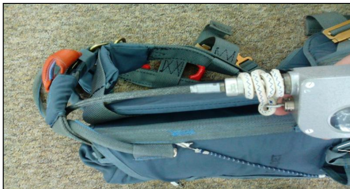
Fig. 9. Przełożenie węża automatu pod taśmą nośną spadochronu L-2 „Kadet” (zdjęcie automatu z linką i kołkiem giętkim o długości 400mm).
