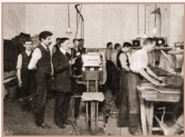
Prasowanie płyt. Prasy hydrauliczne i stoły na parze.
