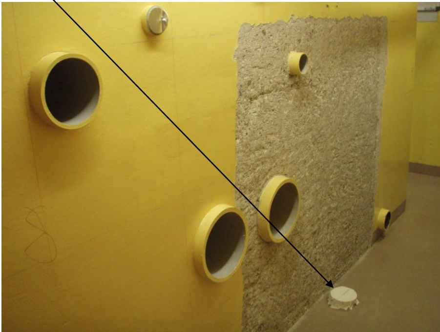
Abb. 5: Abschirmwand mit lokaler Einstrahlung
