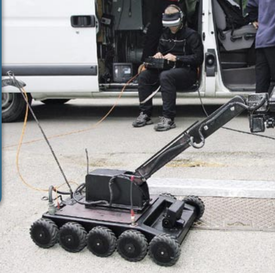
Tečajnik s pomočjo kamere na robotu, s katere se slika prenaša na očala, usmerja delovanje robota.
