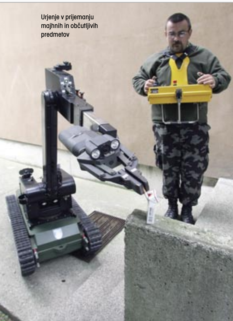
Tečajnik s pomočjo kamere na robotu, s katere se slika prenaša na očala, usmerja delovanje robota.
