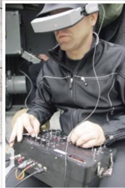
Tečajnik s pomočjo kamere na robotu, s katere se slika prenaša na očala, usmerja delovanje robota.
