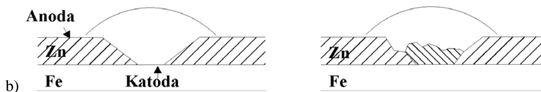
Rys.56. Schemat przebiegu korozji powłok galwanicznych: a) powłoki katodowej, b) powłoki anodowej
