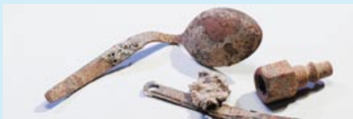
Metallteile nach der Verbrennung in der Kehrichtverrennungsanlage.
