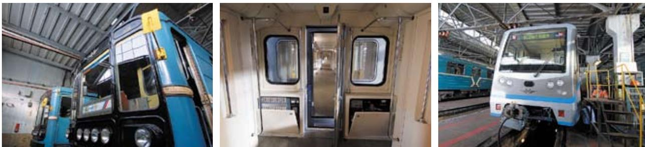
Вагоны моделей 81-740.1/741.1 «Русич» оснащены отечественным асинхронным тяговым электроприводом разработки и производства ОАО «Метровагонмаш».
