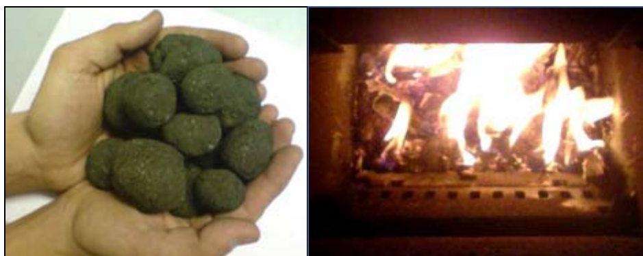
Рис. 6.1. Топливные гранулы и их горение в топке котла
