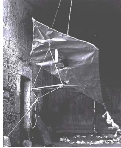
Şekil 10: Fotoğraf makinesi takılmış bir uçurtma (BAUMANN 2001)
