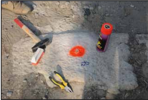
Resim 1-2: Poligon noktalarının D-GPS ile koordinatlandırılması ve sabitlenmesi
