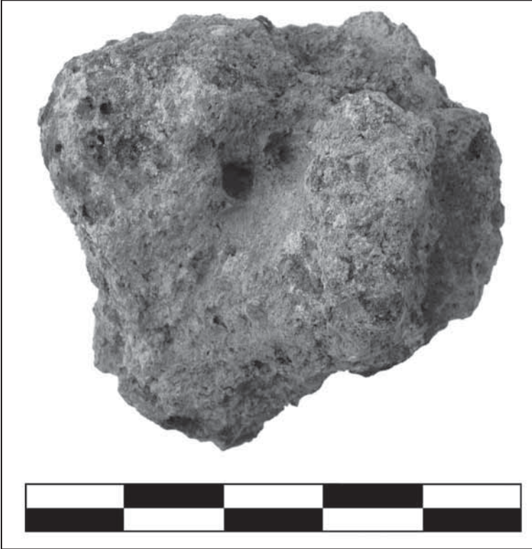
Resim: 8: Cürüflaşmış ocak veya fırın iç sıvası. Yeşil malakit rengi burada bakır ergitildiğini göstermektedir.
