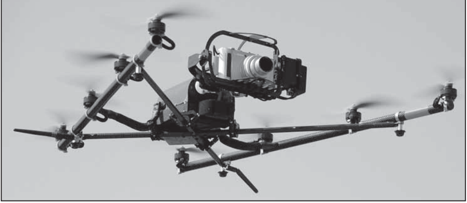
Fig. 7: Oktokopter powered by batteries for digital aerial photographs (photograph H. Marg). Resim 7: Dijital fotoğraf makinesi ile kuşbakışı resimler amacıyla kullanılan oktokopter (Fotoğraf: H. Marg).
