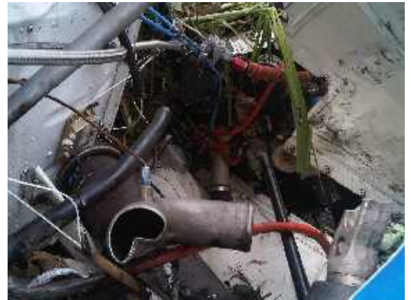
Castillo golpeado y soporte de motor fracturado
