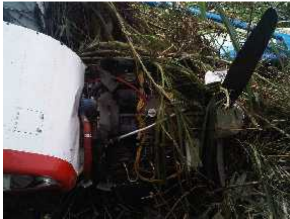
Motor desprendido de su base
