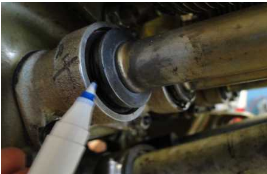
Bases de las varillas actuadoras que estaban instaladas en el motor de la aeronave accidentada
