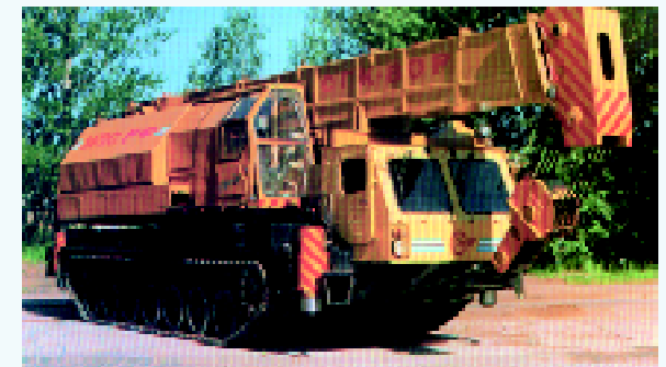
Высокообъемный гусеничный кран СГК-80Р, созданный на базе шасси самоходной пушки 2С7М
