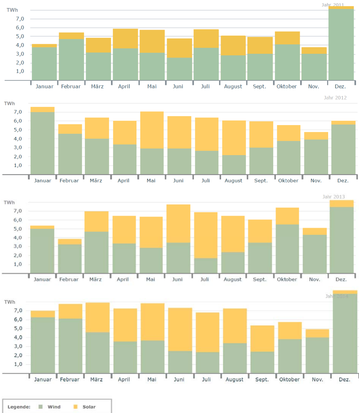
Abbildung 29: Monatliche PV- und Windstromproduktion der Jahre 2011-2014 [ISE4]
