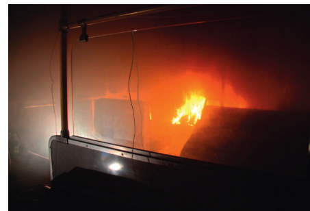
Abb. 2: Entfachen des Feuers im Abteil (Foto: Per Rohlén/METRO-Projekt)
