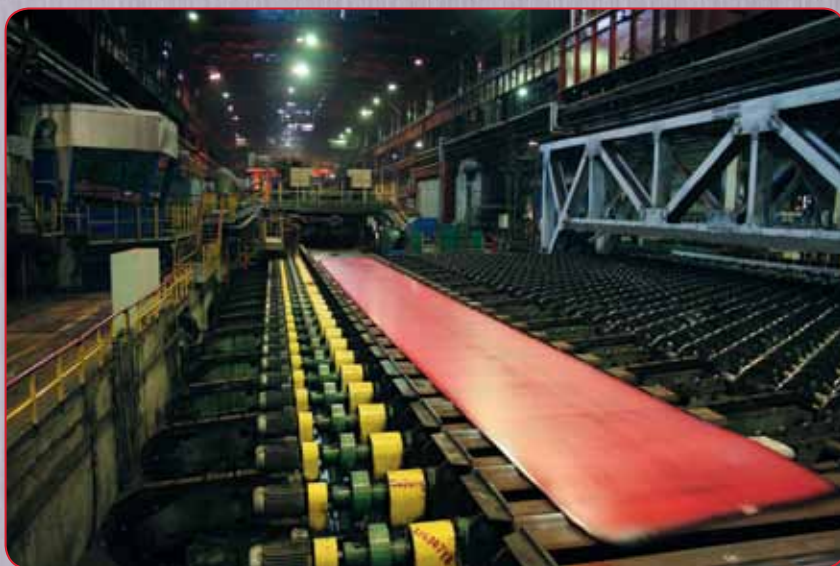
ЛПЦ-1. Реконструированный стан 2800 в работе
