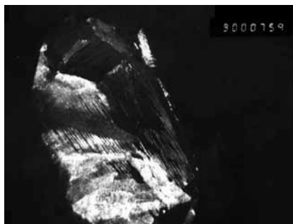
Рис. 7. Пластика углеродистого (двойникованного) мартенсита в тонкой микроструктуре стали после закалки и отпуска при 720\text{ }^\circ\text{C} ; \times 30\,000
