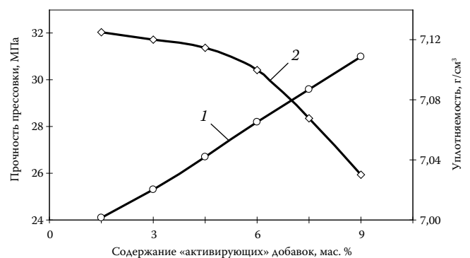
Рис. 2. Влияние концентрации активирующей добавки \text{Fe}_2\text{O}_3 в исходной порошковой шихте на технологические свойства «высокоактивного» воздухомаслянного железного порошка:
