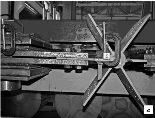
Рис. 11. Испытание узла при одноосном растяжении (а) и при сложном нагружении (б)
