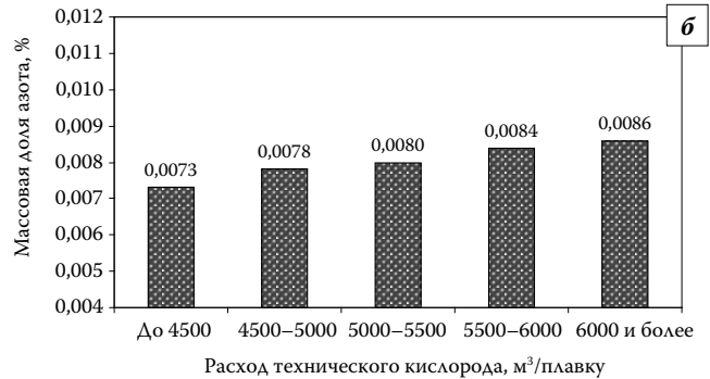
Рис. 3. Зависимость содержания азота в стали от расхода технологического (а) и технического (б) кислорода
