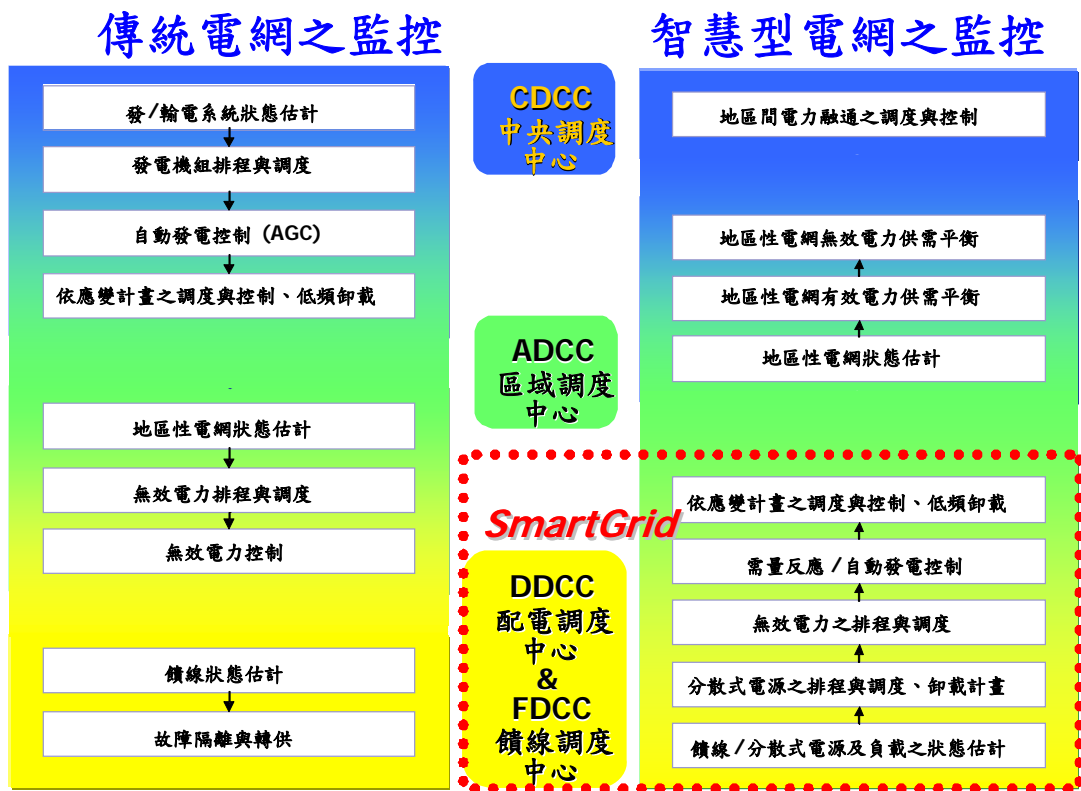
圖 23、慧型電網與傳統電網監控流程比較圖
