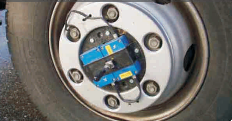
TELEMETRYCZNY SYSTEM DO POMIARU TEMPERATURY TARCZ HAMULCOWYCH
