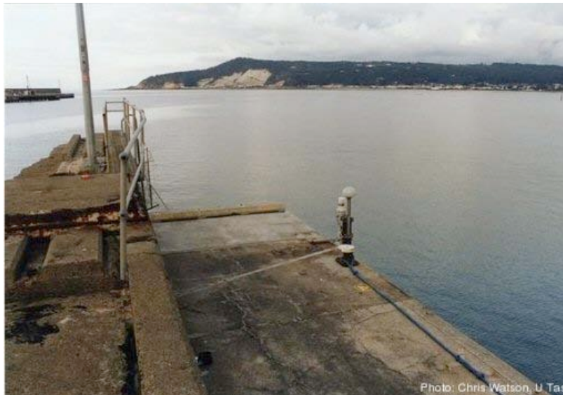
Abbildung 57: Tasmanische Pegelmessstation mit GPS Gerät zur Topex/Poseidon Satelliteneichung 117 Quelle WattsUp. S. Fußnote
