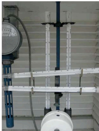
Abbildung 4: Hier werden (links) eine klassische, deutsche Wetterhütte (erweiterter Stevenson Screen) und (rechts) ein darin befindliches modernes Thermometerensemble gezeigt, wie es immer noch in vielfältiger Verwendung ist. Die senkrechten Thermometer sind (links) das Assmannsche Aspirationsthermometer zur Temperaturmessung, links daneben ein befeuchtetes und belüftetes Psychrometer zur Messung der Luftfeuchte. Quer darunter befinden sich zwei liegende Thermometer zur Messung von Max. und Min. Temperaturen. Die runde Plastiktrommel enthält den Federmotor mit Ventilator zur Erzeugung des Luftstromes mit \varnothing 2,5 m/s vor und während der Messung. Im März 2009 vom Autor im Meteorologischen Institut der Freien Universität Berlin aufgenommen
