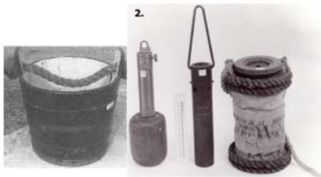
Abbildung 28: Schöpfemerkonstruktionen zur Messung der SST. Links: Holzzeimer verwendet bis Ende des 19. Jahrhunderts (die isolierende Wandung des Holzzeimers, verhindert eine schnelle Abkühlung des Messgutes, rechts: 1. Deutscher Marinepütz (Leder- später gummiummantelt verwendet bis heute, daneben englischer metallischer Pütz, (gab es isoliert und unisoliert), sowie rechts Leinenbucket (die dünne Leinenwand gibt die Wärme des Messgutes deutlich schneller an die Umgebung ab. Aus [FOLLAND, 1995]
