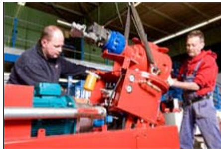
Zusammenbau einer Betonspritzmaschine: Solche Geräte machen auf der Baustelle nahezu staubfreies Arbeiten möglich. Fotos: Moll (3)
