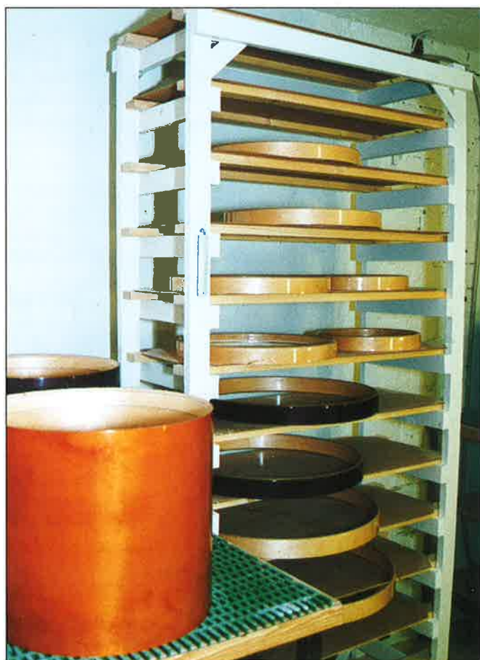
Maalattuja ja lakattuja runkoja sekä vanteita kuivumassa.
