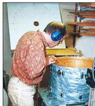
Rummun reunaviisteet ajetaan uusiksi alajyrsimellä. Taustalla taulu, jonka avulla porattavien reikien paikat rakenteilla olevan rummun runkoon saadaan mitoitettua millien tarkkuudella.
