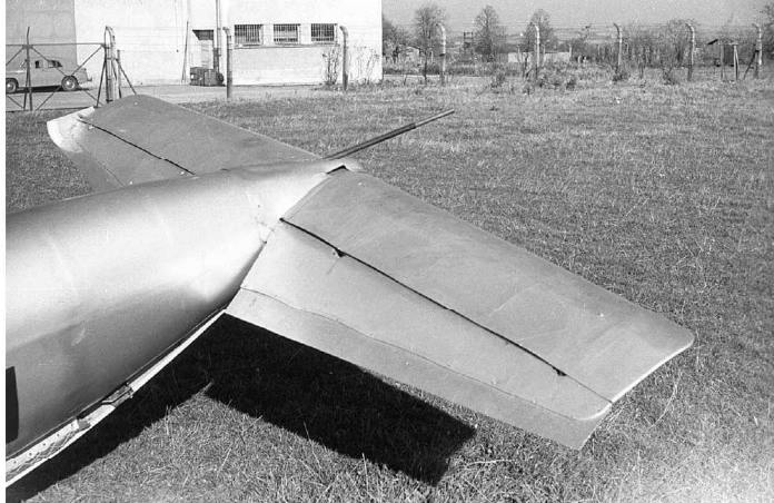
Usterzenie poziome i przyrząd do pomiaru kąta wychylenia steru wysokości
