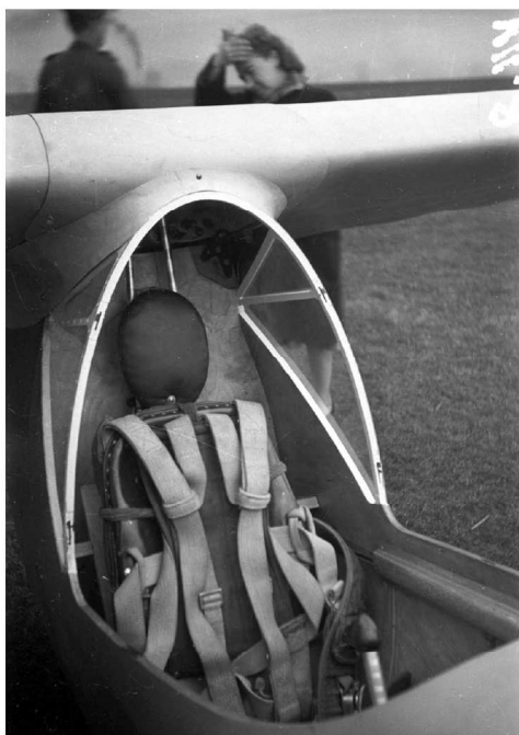
Oparcie fotela pilota. Widoczne stałe przeszklenie.
