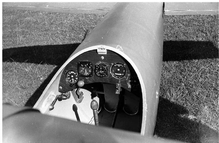
Kabina pilota. Widoczna korbka otwierania hamulców lub przesuwania ciężarka wyważającego
