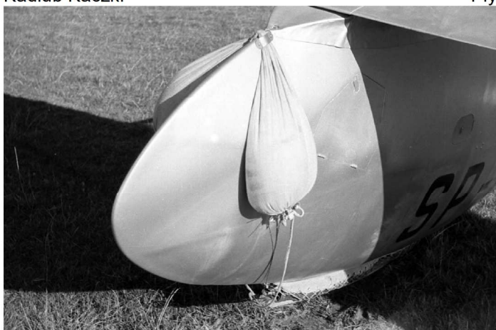
Balast używany przed montażem ruchomego ciężarka
