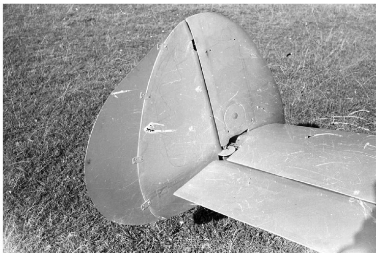
Płyta brzoźowa o zwiększonej powierzchni
