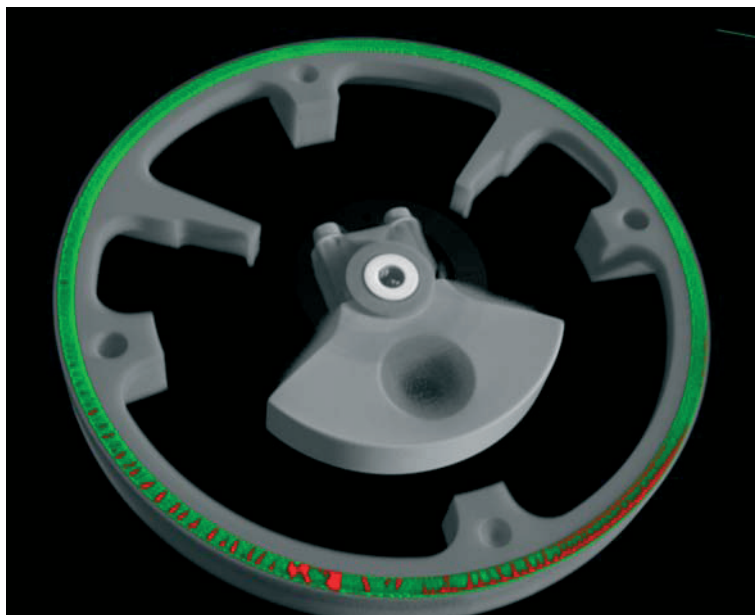
Tomographie de la sonde En vert, le joint torique d'étanchéité. La couleur rouge représente une densité moindre de matière
