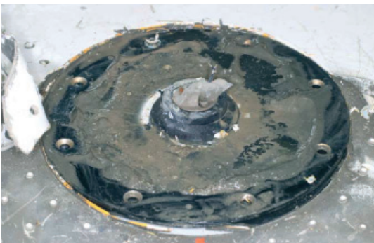
Dessus de la sonde après enlèvement de la plaque de fixation (présence de peinture jaune)
