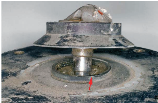
Pellicule souple dans le logement d'entrée de la sonde, sous l'embase de la girouette
