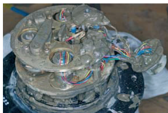
Intérieur de la sonde garni de vase
