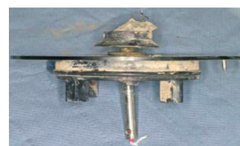
Axe de la girouette fléchi, encore en place dans le palier supérieur du dessus de la sonde
