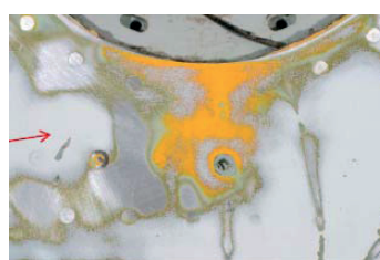
Environnement de la sonde localement poncé
