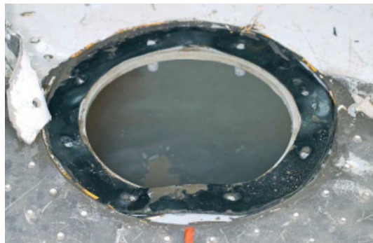
Emplacement de la sonde sur joint dans la structure avion (présence de peinture jaune)
