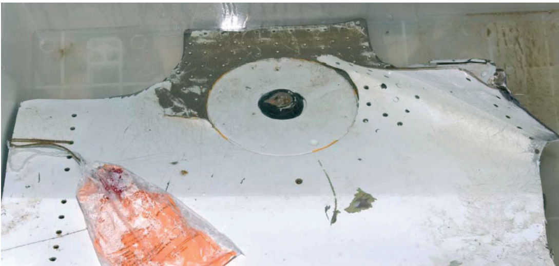
Sonde d'incidence fixée à la structure avion
