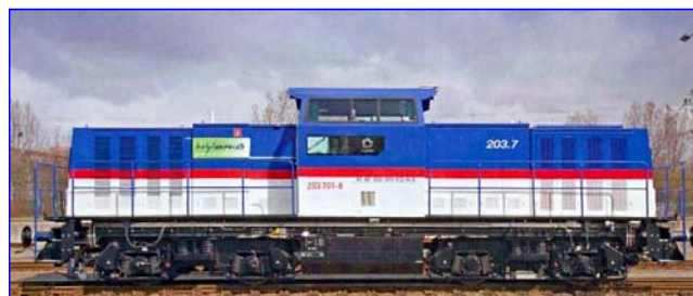
Rys. 8 – Hybrydowa lokomotywa spalinowa BR203 firmy Alstom
