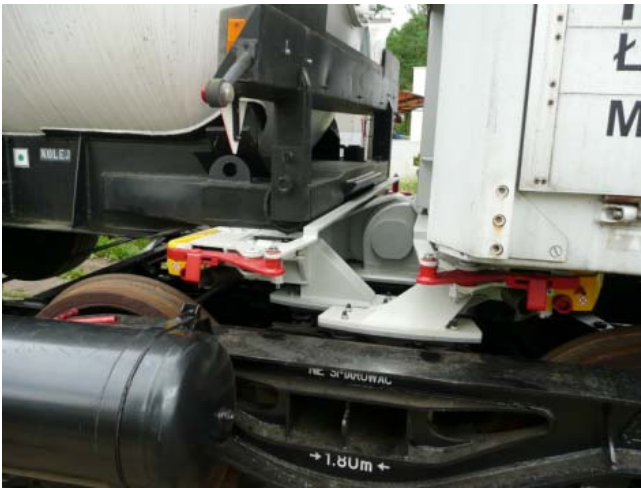
Fot. 2. Zamocowanie naczepy na adapterze środkowym
