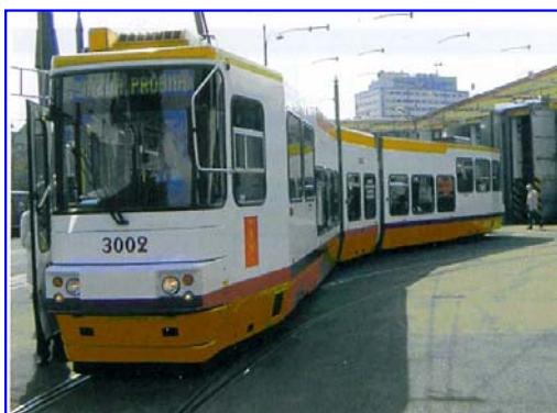
Rys. 4 – Tramwaj typu 116N z akumulatorowym zasobnikiem energii
