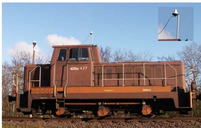
Rys. 2. Lokomotywa manewrowa 401Da z zainstalowanym terminalem satelitarnym TT-3026L [2]
