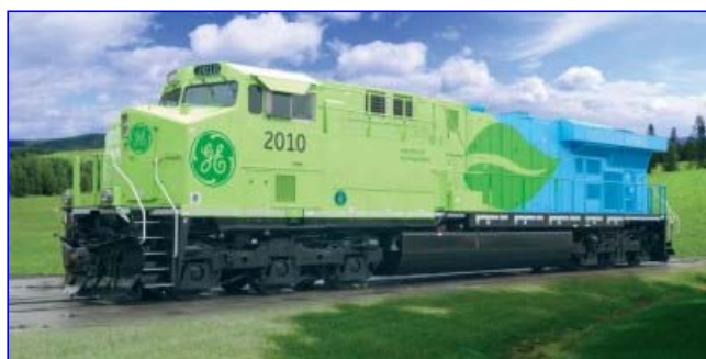
Rys. 7 – Spalinowa lokomotywa hybrydowa 2010 GE Evolution Hybrid firmy General Electric
