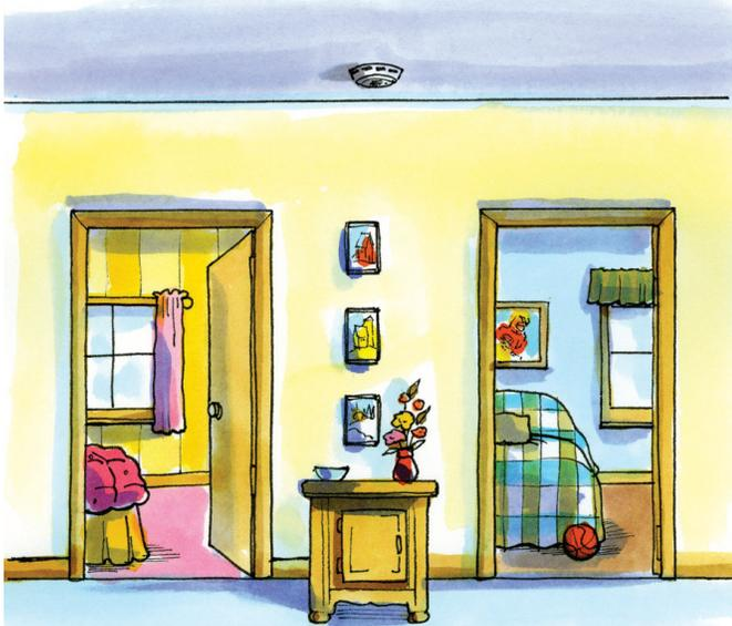
Betätigen Sie mindestens einmal im Monat den Testschalter, um sicherzustellen, dass der Rauchmelder auch funktioniert.
