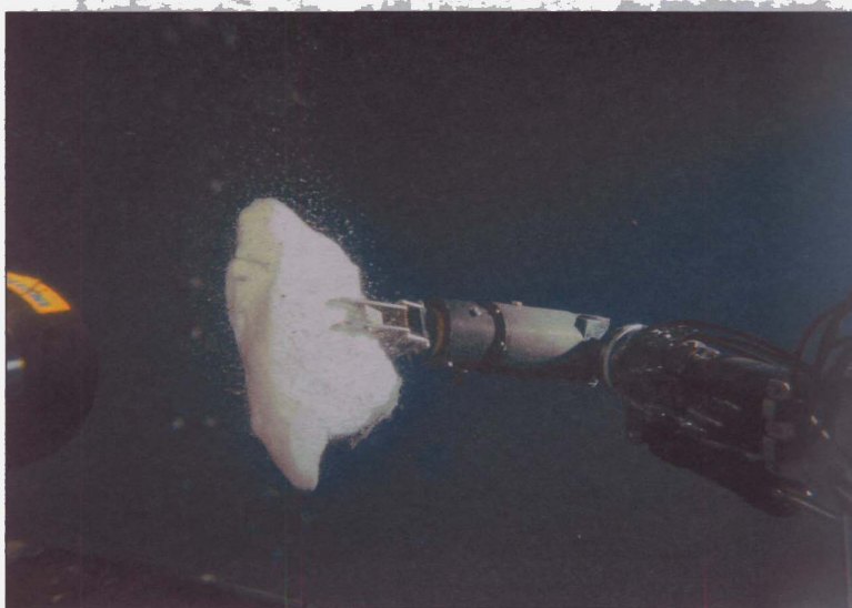
Монолитный газогидратный холм под слоем осадка (вверху) и кусок твердого газогидрата в манипуляторе аппарата «Мир».
