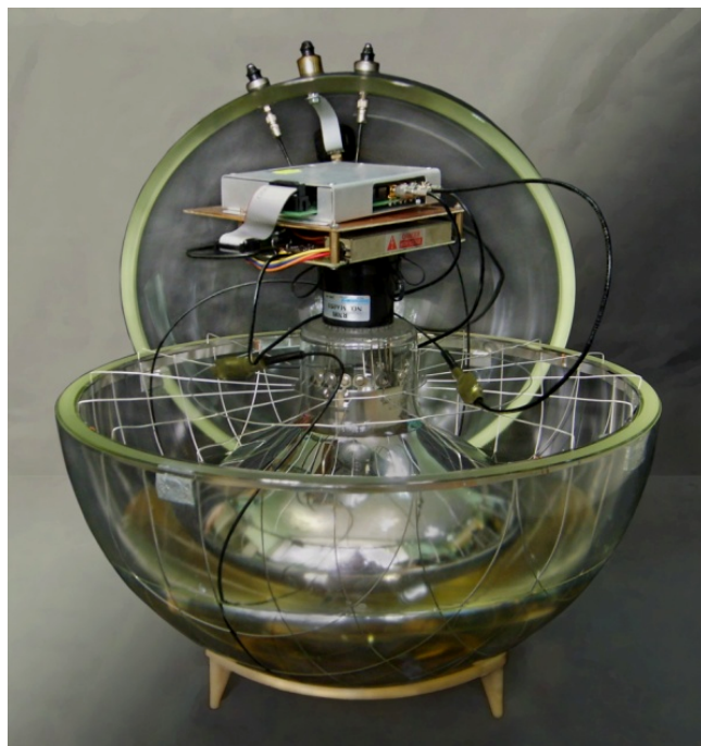
Рис. 4.1.4: Оптический модуль с ФЭУ R7081HQE, защитным экраном из пермаллоя и комплектом электроники.
