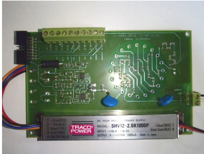
Рис. 4.1.2: Плата усилителя и делителя с установленным блоком высоковольтного питания.
