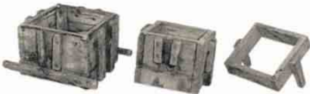
Formekasser i tre. Slike ble benyttet i støpingen ved de fleste jernverker i første halvdel av 1800 – tallet.
