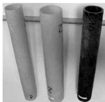
Рис. 2. Готовые изделия из композиционных материалов в виде трубок
