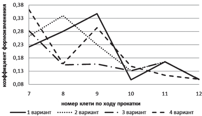
Рис.3. Распределение коэффициента формоизменения K_{инф} при прокатке круглого профиля диаметром 28 мм на стане «350».
