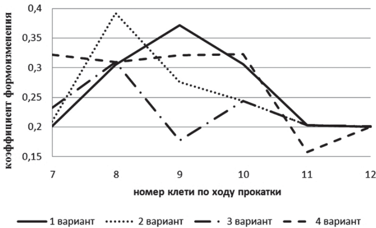
Рис. 4. Распределение коэффициента формоизменения K_{зв} при прокатке круглого профиля диаметром 28 мм на стане «350»
