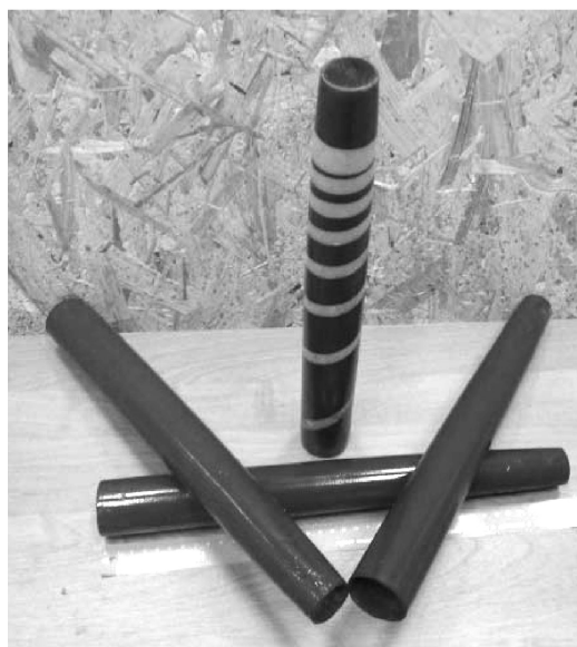
Рис. 1. Модель четырехсекционной опоры в разобранном состоянии (а) и в сборе (б)
