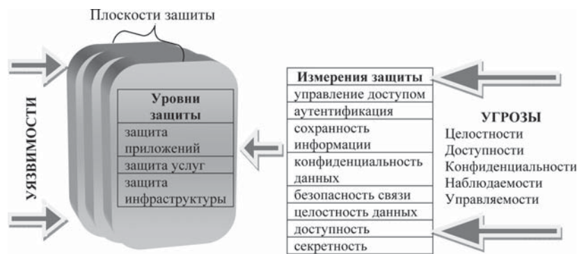
Рис. 1. Архитектура защиты систем, обеспечивающих связь между оконечными устройствами
