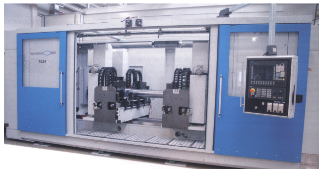
Rys.1. Maszyna do automatycznego wałczkowania osi zestawów kołowych firmy Hegenscheidt- MFD GmbH & Co.KG w Erkelenz wg [1]
