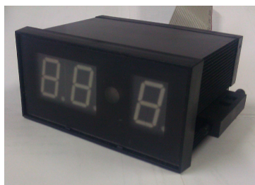
Rys.4. Wyświetlacz pozycji elektronicznego nastawnika jazdy i boczniowania
