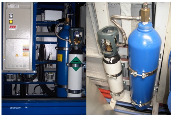
Rys.4 Schemat instalacji gaśniczej firmy Fogtec dla lokomotywy spalinowej serii ST46
