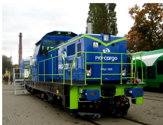
Rys.2 Widok zmodernizowanej lokomotywy SM42 (6Dk) wykonanej przez Pesa Bydgoszcz
