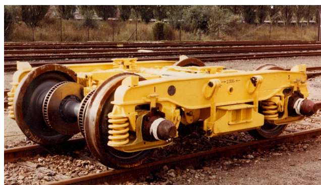
Rys.1. Wózek Y37 wagonów towarowych eksploatowany przez SNCF, wyposażony w hamulce tarczowe
