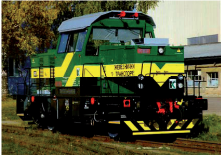
Rys. 12. Modułowe konstrukcje lokomotyw dwuosioowych typu 709 (a) i 719 (b) z silnikami spalinowymi CAT C15 o mocy 403 kW
