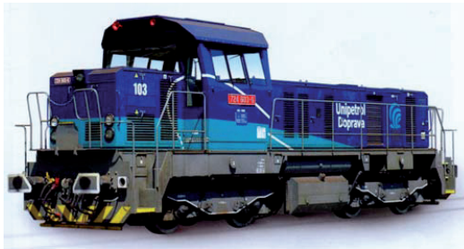
Rys. 13. Modułowe konstrukcje lokomotyw czterosioowych typu 724.6/724.7 (a) z silnikami CAT C15 i CAT C27 oraz 741.7/742.7 (b) z silnikiem CAT 3508C o mocach 403, 709 i 1000 kW
