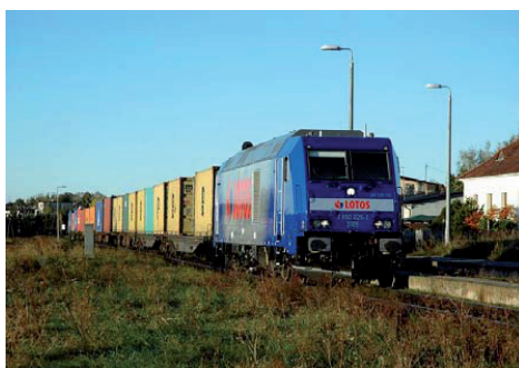
Rys. 3. Lokomotywa spalinowa serii 285 (TRAXX F140 DE)
