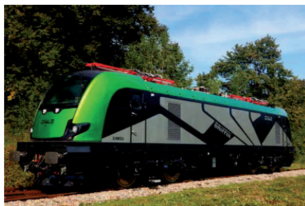
Rys. 7. Lokomotywa elektryczna wielosystemowa E4MSU Griffin firmy ZNLE Gliwice
