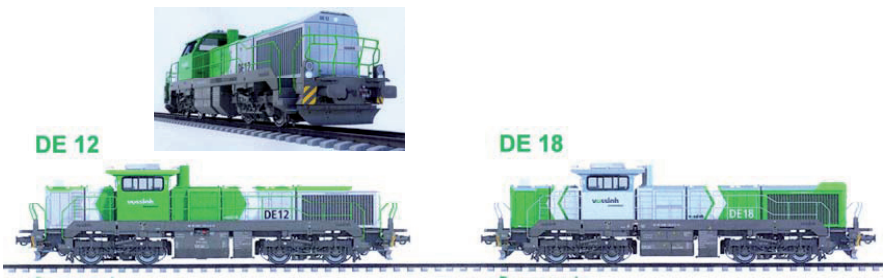
Rys. 8. Nowe lokomotywy o budowie modułowej firmy Vossloh a – trzyosiowa typu G 6 z przekładnią hydrauliczną b – czteroosiowe G 12/G 18 z przekładnią hydrauliczną c – czteroosiowe typu DE 12/DE 18 z przekładnią elektryczną
