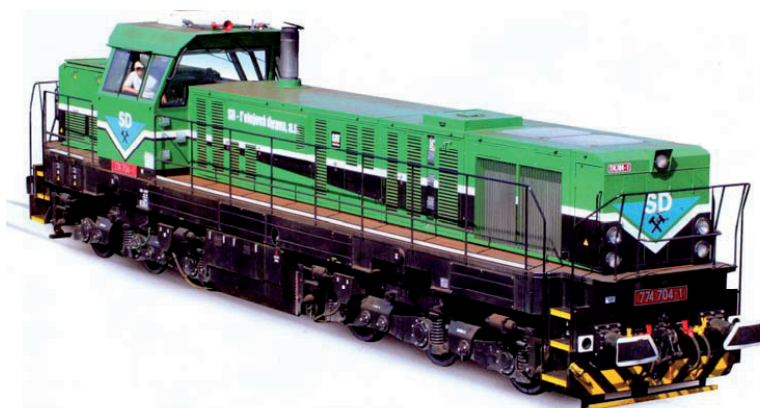
Rys. 14. Modułowa konstrukcja lokomotywy sześćoosiowej typu 774.7 z silnikiem CAT 3508C lub CAT 3512C o mocach 1000 lub 1550 kW
