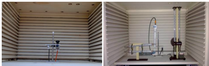
Wnętrze klatki meteorologicznej z termometrami rtęciowymi i czujnikiem elektrycznym (źródło: Instrukcja dla stacji meteorologicznych 2005)
