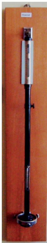
Barometr rtęciowy wykorzystywany do 2013 roku; fot. R. Kurowska-Łazarz
