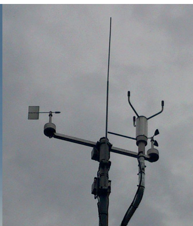
Wiatromierz ultradźwiękowy WS425 firmy Vaisala (1), anemometr czaszowy (2) oraz stery kierunkowe (3); fot. B. Woźniak
