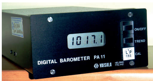
Obecnie stosowany na stacjach synoptycznych barometr PA11 fot. R. Kurowska-Łazarz
