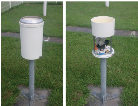
Elektroniczny deszczomierz rejestrujący RG-50 SEBA i jego wnętrze; fol. B. Woźniak
