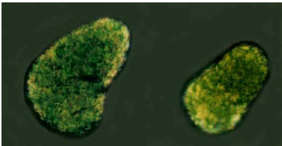
Fot. 5.1. Obraz mikroskopowy ziaren glaukonitu z Nowodworu. Pow. 300X
