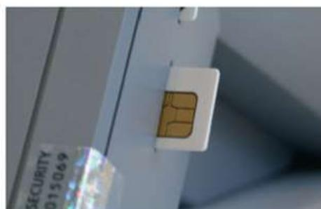
Für den Zugang zur TI-Plattform wird der Chip der SMC-B Karte herausgebrochen und in die Sicherheitseinheit des Leseterminals eingesetzt.
